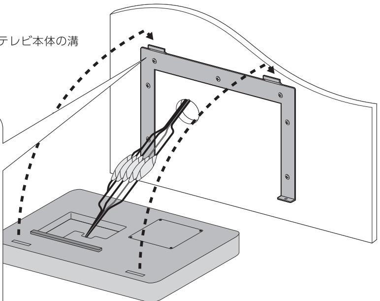
②取付金具の下部 2箇所をネジ止めします。
